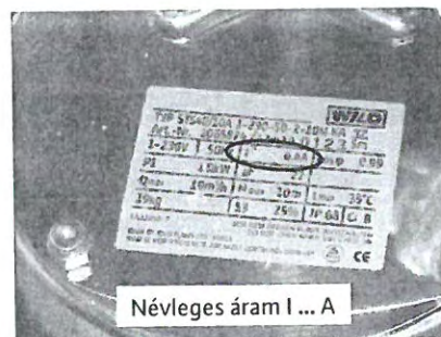
13. ábra: Szivattyú adattábla
